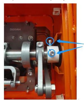
卸下内部固定的两个螺丝 remove the clamp screws
