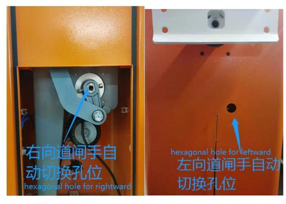
② 若杆子在开到位,顺时针转动 L 型扳手为手动挡; 若杆子在关到位,逆时针转动 L 型扳手为手动挡;
