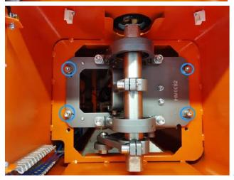
将机芯旋转180°后置入机箱,并更换另一幅 孔位固定
