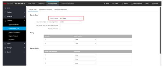
然后在车辆管理中设置临时车、黑名单车辆、白名单车辆的放行规则。在下方手动控制道闸 开关可以测试相机和道闸是否接线正常
